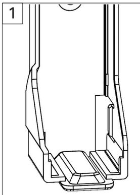
Montieren Sie die Dichtung mittig in den Clip.
